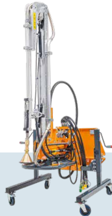
■ hydraulischer Gießarm mit einstellbaren Drosseln
